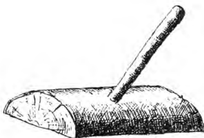
23. Севернорусское приспособление для трамбовки тока. Вологодская губ., Сольвычегодский уезд
