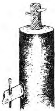
22. Севернорусский цеп: способ соединения двух его частей. Вологодская губ., Сольвычегодский уезд
